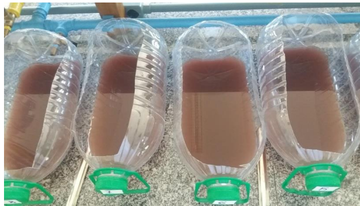
Figura 2 - Frascos adaptados para os ensaios com agitação manual periódica.
