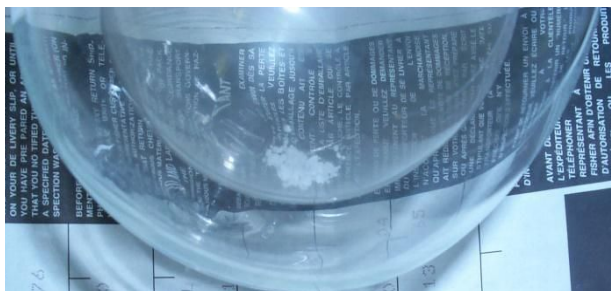
Figura 4. Exemplo de outra unidade, com frasco contendo dióxido de carbono congelado após volatilização da amostra de oxigênio. Fonte: White Martins, 2008.
